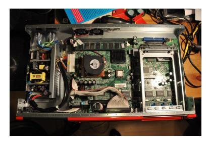
Firebox non ha l'uscita VGA, solo un attacco per la console, per cui, al fine di leggere la shell, vi occorre un cavo seriale per interfacciare l'hd al vostro pc, solitamente a corredo.
